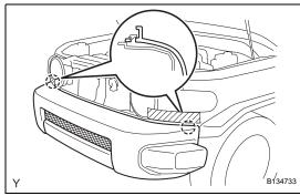
(d) Disengage the 2 claws and remove the front bumper cover.
